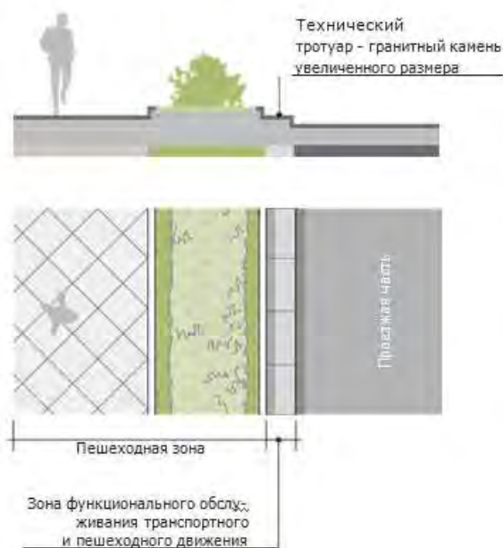
Технический тротуар, примыкающий к пешеходному тротуару на одном уровне
