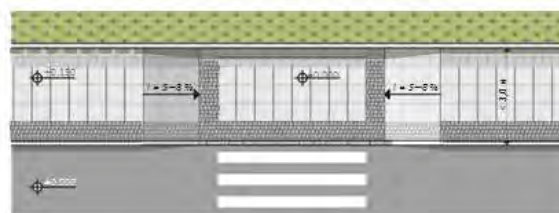
Схема 4-2. Пример организации предупреждающих покрытий при помощи изменения цвета, фактуры и типа укладки
