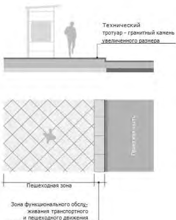
Технический тротуар, примыкающий к пешеходному тротуару на одном уровне
