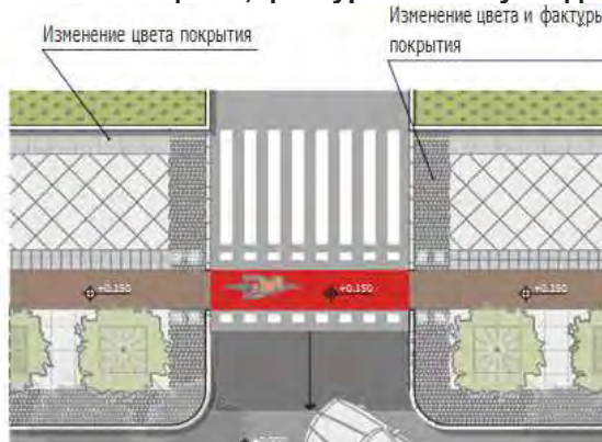
Схема 3-1. Пример организации предупреждающих покрытий при помощи изменения цвета, фактуры. Размещение тактильных указателей и типа укладки
