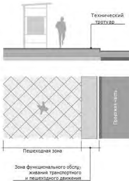
Технический тротуар, примыкающий к пешеходному тротуару на одном уровне
