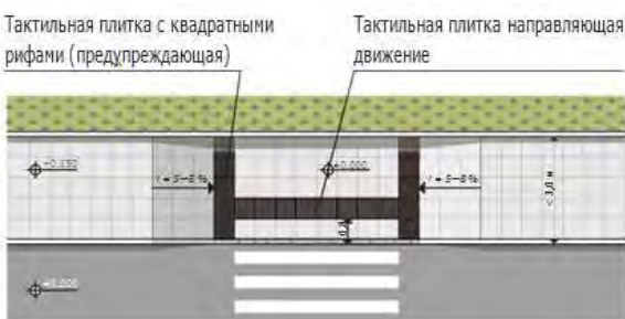
Схема 4-2. Пример организации предупреждающих покрытий при помощи изменения цвета, фактуры и типа укладки
